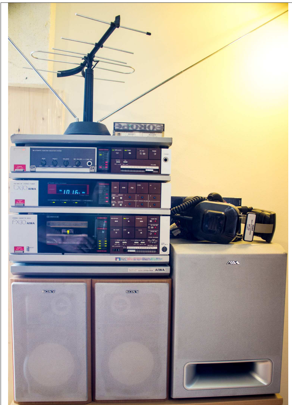
Čelní pohled na celou věž – svítí zelená podsvícená plocha za kazetou = optická indikace množství pásku kazety
