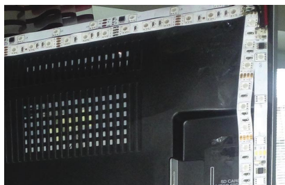
Obr. 1. Umístění LED pásu na zadní plochu TV Sharp Quattron 3D. Jsou vidět 2 pásy (vnější WS2812 a vnitřní RGB – starší pokusy s analogovým signálem). Dbáme na dodržení směru lepení ve směru šipky pásu. Máme osvit po všech čtyřech hranách TV, takový jako mají jenom nejdražší TV přijímače
